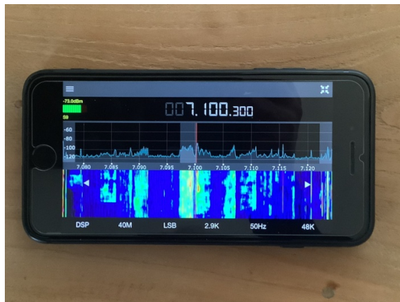
Bild 22: Fernsteuerung eines SDR über den Browser eines Smartphones (WWW)
