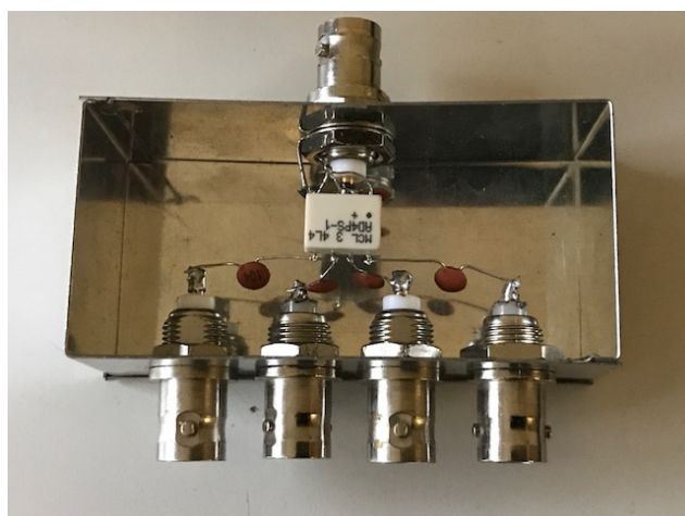
Bild 23: Aufbau eines 5-Port Antennen-Splitter mit dem Hybrid-Baustein AD4PS-1
