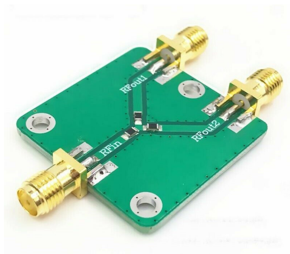
Bild 16: Resistive 3-Port Power-Splitter, Eigenbau (links) und eBay (rechts)
