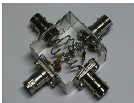
Bild 6: Versuchsaufbau eines 433 MHz-Wilkinson-Teilers 1 auf 2 und 1 auf 3 mit L-C-Kreisen
