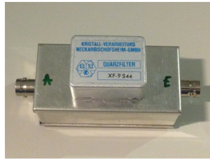
Bild 9: Verwendetes 9MHz Quarzfilter mit 50 Ohm Anpassung über MCL-Übertrager
