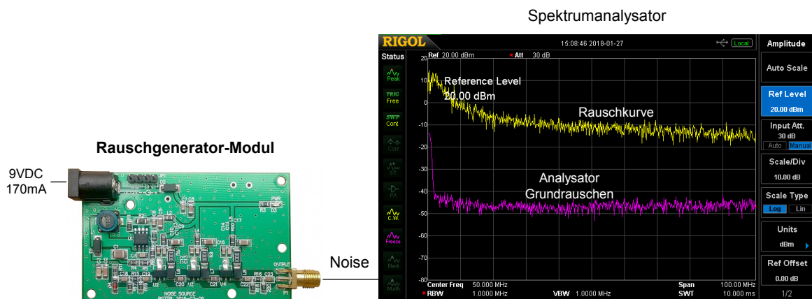
Bild 2: Rauschkurve des Generators von 0-100MHz, Auflösungsbandbreite 1MHz, Dämpfung 30dB
