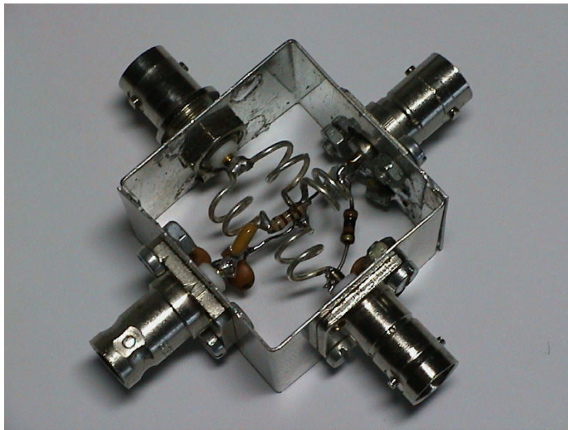
Bild 18: Versuchsaufbau eines Wilkinson-Teilers „1 auf 3“
