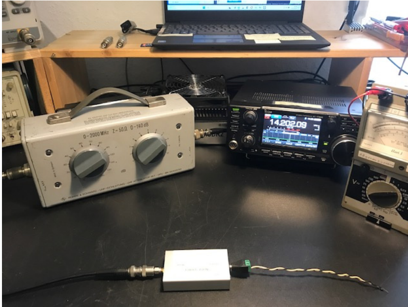
Bild 7: Rauschmessplatz, 0.1 bis 1000 MHz
