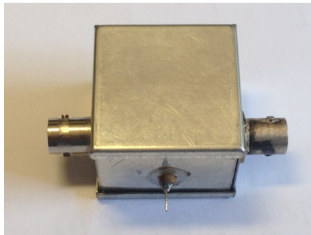
Bild 15: Verstärker im Blechgehäuse inklusive zwei Relais, viel Platz bleibt da nicht mehr
