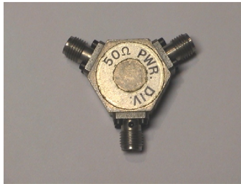
Bild 3: Beispiel eines resistiven Power-Splitters, 0-18 GHz
