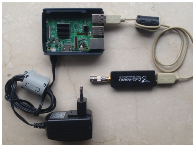
Bild 15: Direktabtastender SDR-Receiver mit RPi3 als Server
