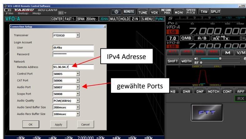
**Bild 17: IPv4-Adresse und Ports in Connection Setup eingeben**
