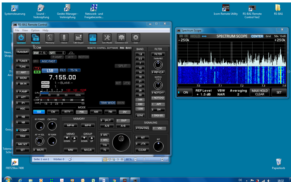
Bild 10: Fernsteuerung des IC-7300 über einem direkt verbundenen PC (USB-Schnittstelle)
