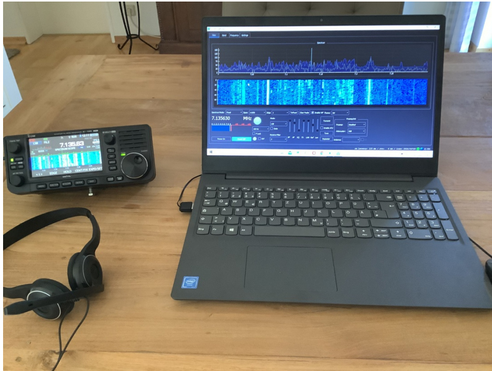
Bild 1: Fernbedienung des IC-705 mit der Software "wfview"
