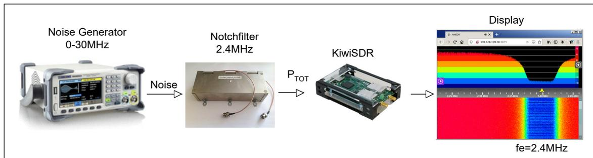
**Bild 12: NPR-Messaufbau**
