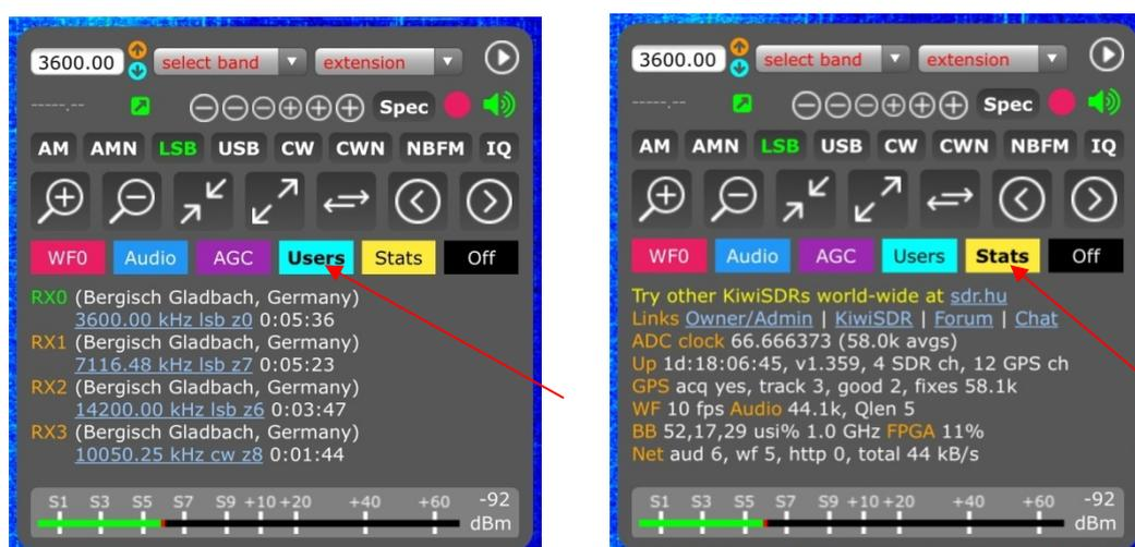
**Bild 6: Vier User auf unterschiedlichen Frequenzen (links), KiwiSDR Einstellungen (rechts)**
