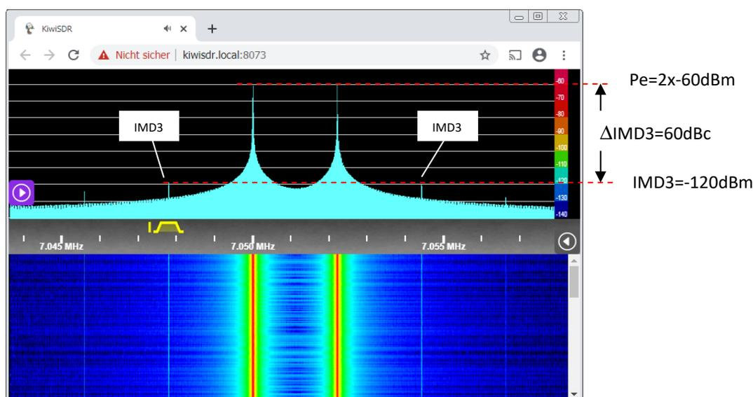
Bild 8: IMD3-Verzerrungen des KiwiSDR bei  $P_e=2x-60\text{dBm}$ :  $\text{IMD3}=-120\text{dBm}$
