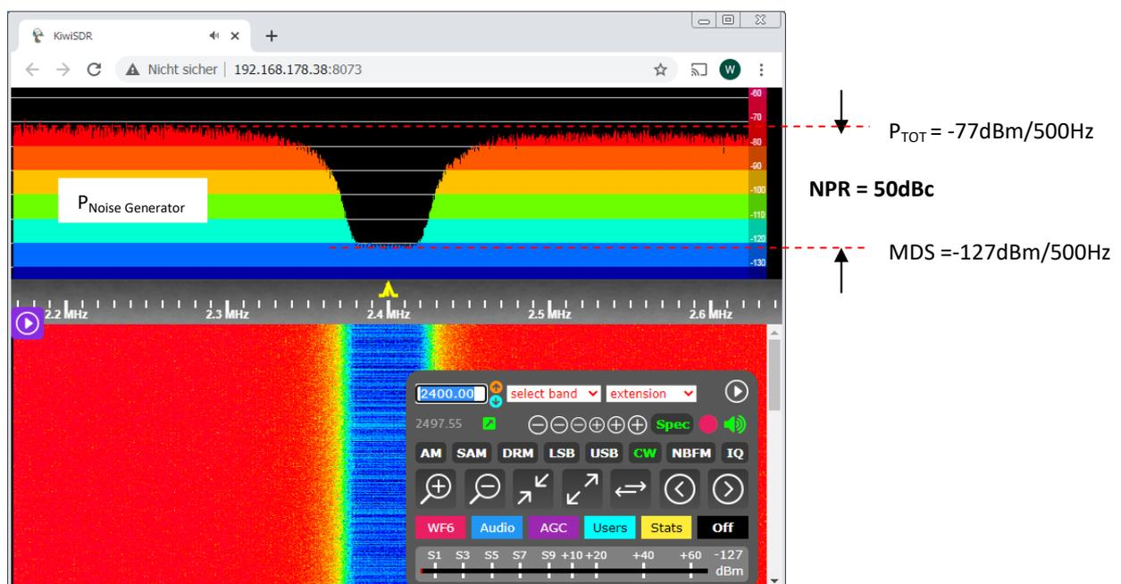
**Bild 13: Noise Power Ratio (NPR) = 50dBc**
