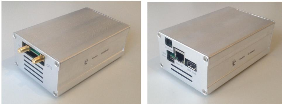
Bild 16: KiwiSDR in einem Alu-Gehäuse
