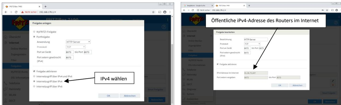
**Bild 4: Port-Freigabe im Router mit Internetzugriff über IPv4**
