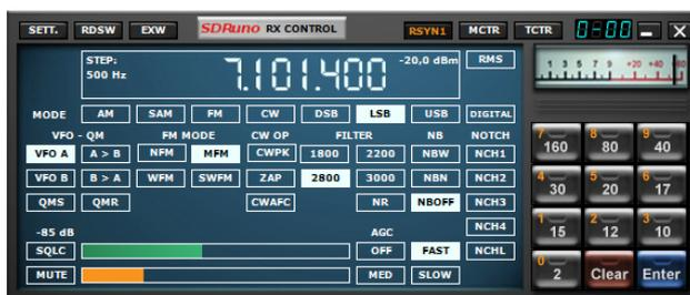
Bild 13: RX-Control von SDRuno mit eingblendetem S-Meter
