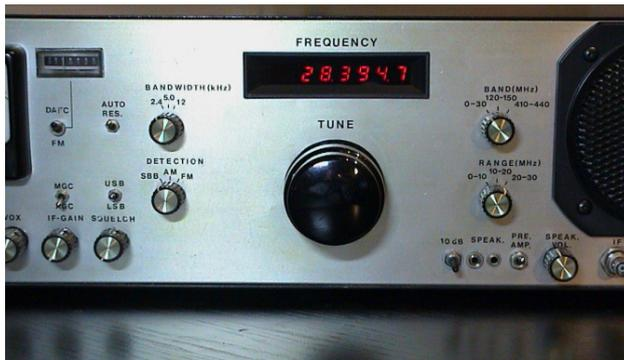
Daten des KW-Empfänger: Empfindlichkeit =  $-128dBm@2,4kHz$ , HF-Eingang 0-30MHz,  $IP_3 = +30dBm$
