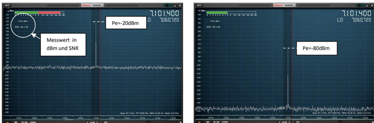
Bild 9: Pegelmessung bei 7,1MHz: Pe=-20dBm -> Messwert -19,9dBm (links), Pe=80dBm -> Messwert -79,9dBm (rechts)
