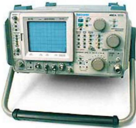
Zunächst messe ich das NPR meines Spektrumanalysators. Ein Analysator eignet sich gut für eine NPR-Messung, weil er die Übersteuerung und das erreichbare NPR direkt an seinem Bildschirm anzeigt. Zuerst gleichen wir den Analysator auf die Mittenfrequenz des Notchfilters ab und erhöhen die Frequenzauflösung auf 50kHz/Teil bei einer Auflösung von 10kHz, so dass der Verlauf des Filters im Bildschirm gut zu erkennen ist (Bild 16).
