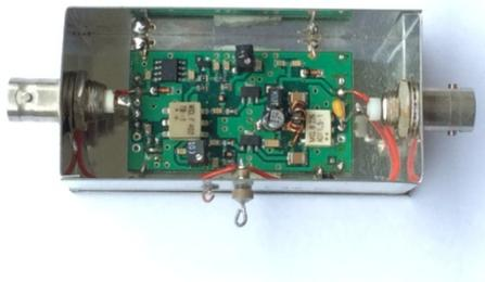
Verwendeter HF-Verstärker,  $f=1-100\text{MHz}$ ,  $\text{Gain}=20\text{dB}$
