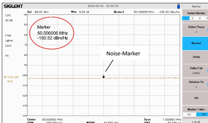
**Bild 5: Messung des Rauschens mit vorgeschaltetem Verstärker:  $-150,5\text{dBm/Hz}$**
