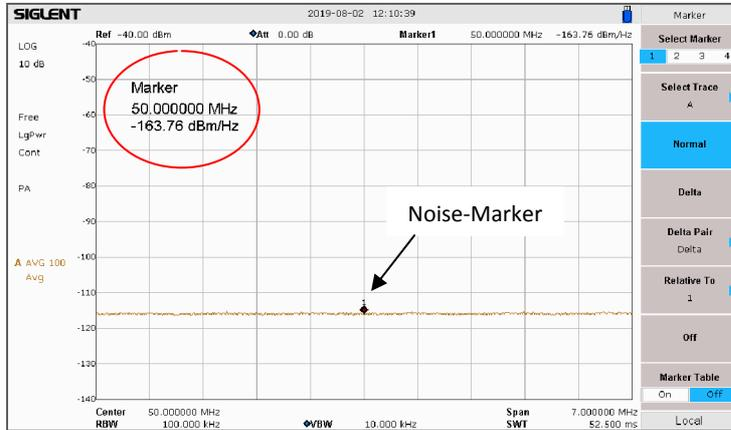
**Bild 3: Messung des Analysator-Grundrauschens:  $-164\text{dBm/Hz}$**
