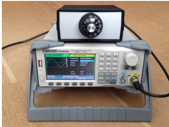
Bild 10: SDG6022X mit einem zusätzlichen, stellbaren Dämpfungsglied 0-70dB
