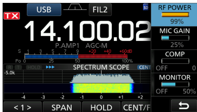
Bild 5: Rauschspektrum am Spectrum Scope des Transceivers, B=2.4kHz (SSB)
