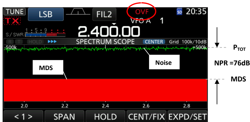
Bild 8: Alternative NPR-Messung bei 2.4MHz über die OVF-Anzeige, NPR = 76dB
